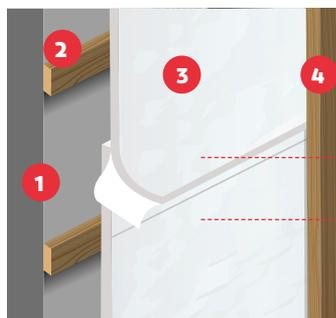
Recouvrement de 10 cm avec la bande adhésive intégrée
