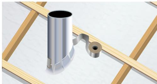
Dans le cas d'une pose avec tuile à douille : Inciser en quartiers l'écran SKYTECH® PRO XL au droit du conduit et joindre par application de la bande adhésive REFLEXBOND XL.
