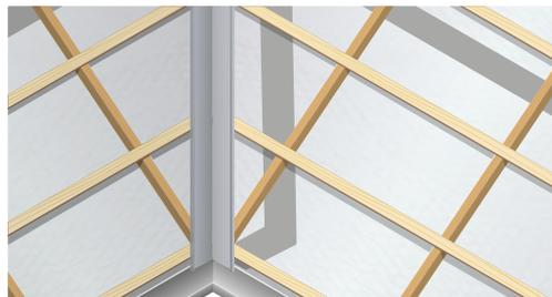
Découper un lé selon l'axe de la noe. Parallèlement à l'axe de la noe, recouvrir de 30 cm le lé sur le versant opposé.
