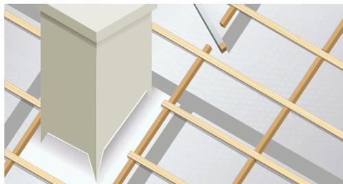
SKYTECH® PRO XL grâce à ses propriétés de réaction au feu, peut s'appliquer directement sur l'entourage de cheminées.
